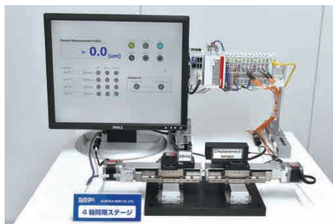
EPC(CX5140)により、4軸同期制御で \pm 1.0 ( \mu\text{m} )の同期精度を実現。更にIPC (C6670)が連携しデータの更新・管理を行う
