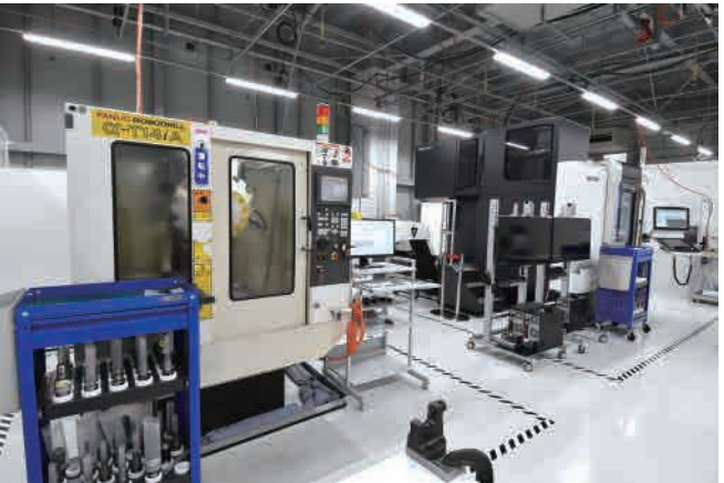
「SURUGA CPS Lab」の様子。左側が保有する最古の設備、右側が最新の設備である。古い工作機械でも新しい工作機械でも問題なく使えるかどうかを検証する
