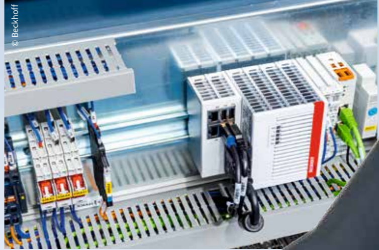
© Beckhoff Intel® Atom™ クアッドコアプロセッサ搭載 組込み型 PCのCX5140は、全てのロボット軸の動作を計算する と同時に、ハンドリングの可視化も実現します。
