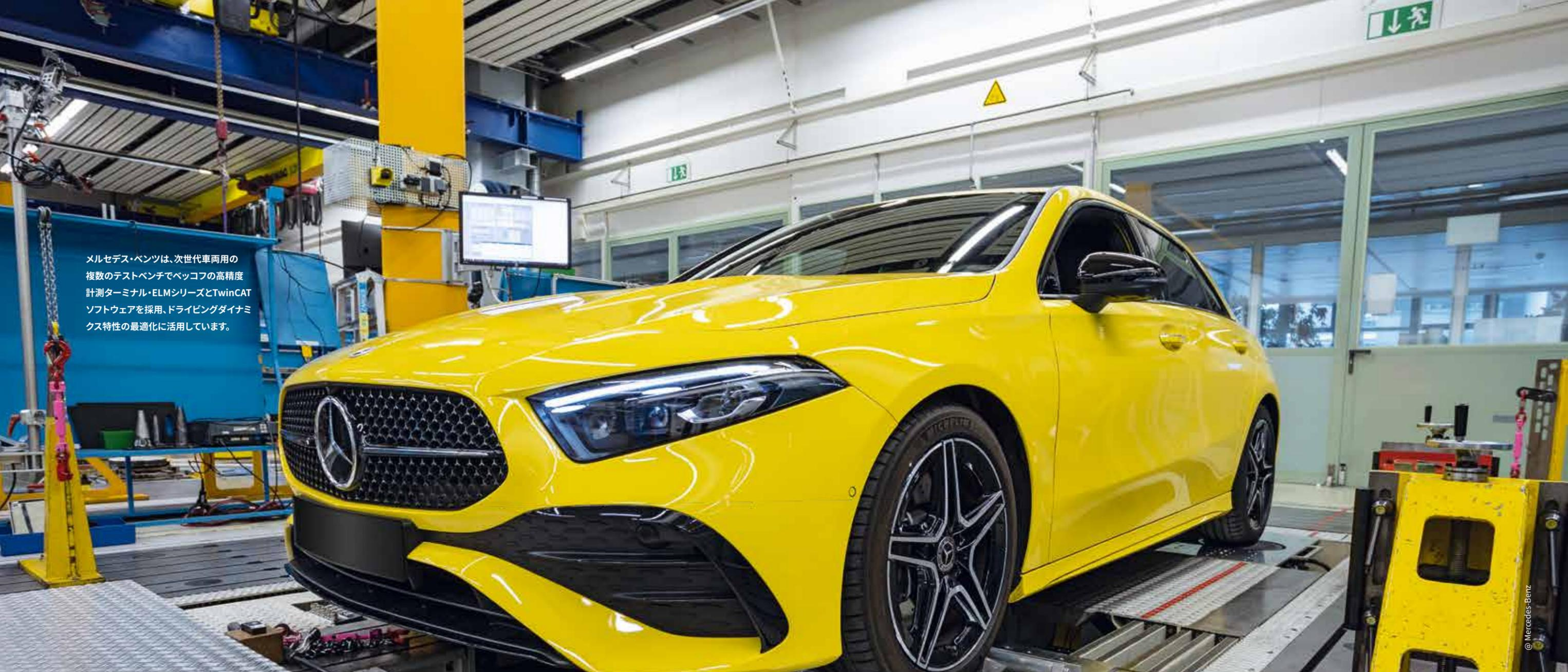
メルセデス・ベンツは、次世代車両用の複数のテストベンチでベッコフの高精度計測ターミナル・ELMシリーズとTwinCATソフトウェアを採用、ドライビングダイナミクス特性の最適化に活用しています。
