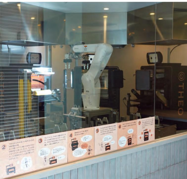
のだ。まだ誰も実現したことのないバウムクーヘン職人のAI化という大きな課題のため、ユーハイムはこの分野で開発経験が豊富な松浦電弘社に開発を依頼した。無人化のために導入する予定だった株式会社デンソーウェーブ(以下、デンソーウェーブ)の垂直多関節ロボットの制御においても松浦電弘社は豊富な経験を持っていたことから、最適な選択だったと言えるだろう。
