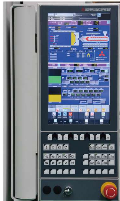
メインコントローラとなるパネル PC CP6216-1xxx。ニーズに合わせてカスタマイズされた操作ボタンに、ソフトウェア PLC の TwinCAT 画面もカスタマイズされ、美しさと分かりやすい HMI を実現できたのもベッコフ PC ベース制御の特徴だ（写真@ベッコフ）
